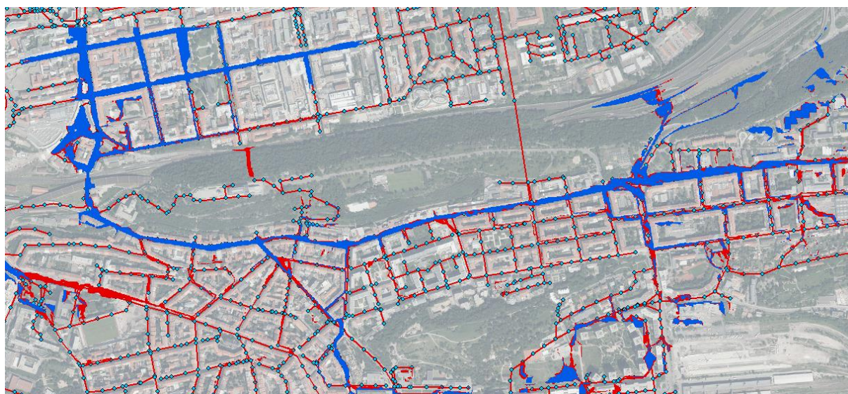
Obr. 61 Rozliv po simulaci Šifaldova deště (červená níže) a blokového deště (modrá výše)
