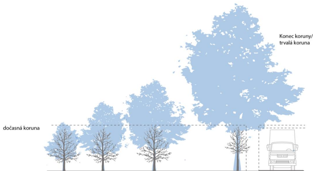
Obr. 8 - Princip práce s dočasnou a trvalou korunou stromu.
