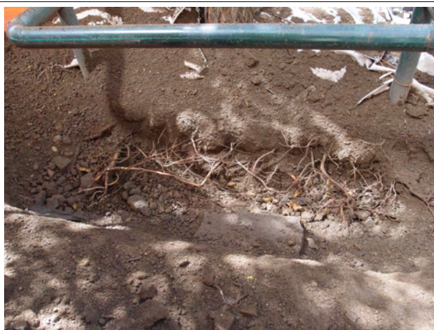
Obr. 7 – Patrná změna intenzity prokořenění na hranici rozhraní zhutněné a nezhutněné půdy.
